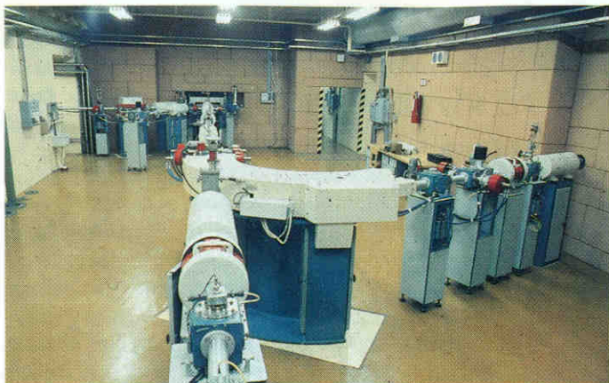
A ciklotron nyálábvezető rendszere
